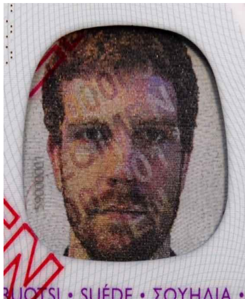
Малюнок 4. Дата народження пред'явника паспортного документа нанесена способом лазерного гравіювання в елементі MLI на полікарбонатній сторінці даних паспортного документа Швеції.
