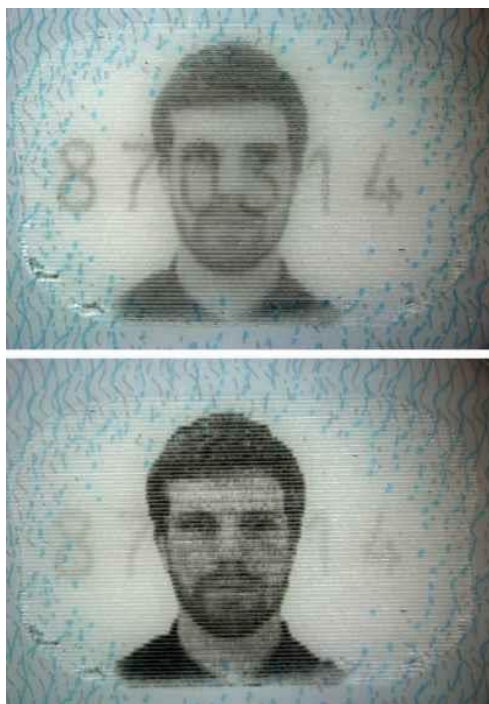
Малюнок 5. Номер паспортного документа внесений у фотозображення пред'явника на сторінці три паспортного документа Швеції струминним друком, як елемент IPI та візуалізується при накладанні декодуючої лінзи.
